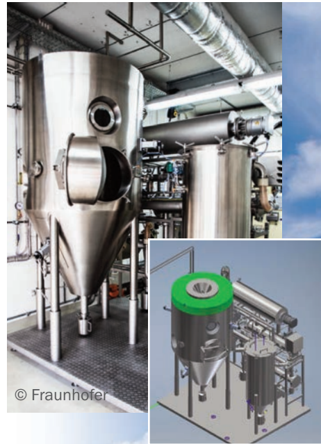
喷雾干燥器 EXPERO SDL-06 应用于中试装置，化工产品
